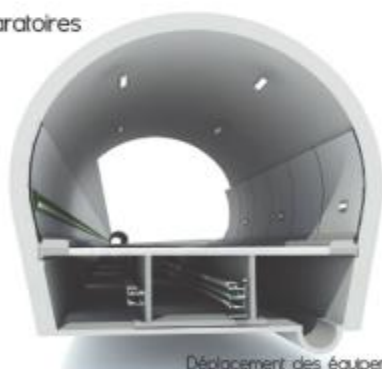
Déplacement des équipements en gaine
